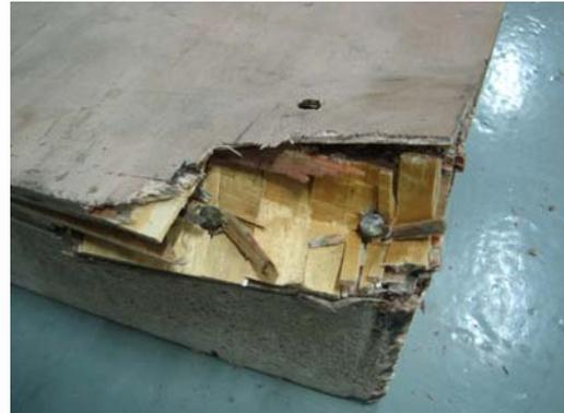
跌落试验后托盘结构失效
