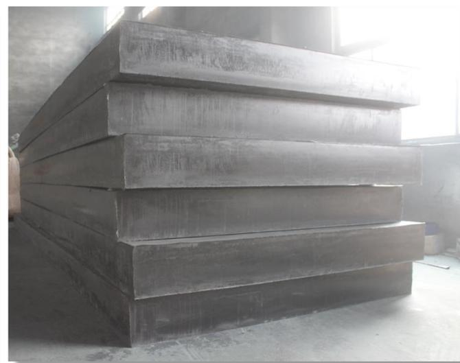
产品主材使用**高分子聚乙烯**或**超高分子量聚乙烯**制成，超高分子量聚乙烯树脂是由乙烯、丁二烯单体在催化剂的作用下聚合而成的粘均分子量大于150万~700万的热塑性工程塑料，被称为“神奇的塑料”。
