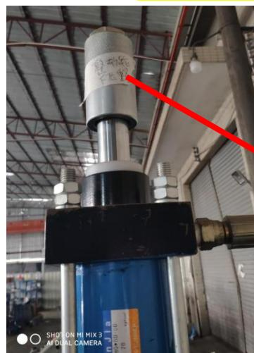
压边轮下压力，应该调这个位于压边轮正上方的油缸螺丝，螺丝向上，则压力加大，螺丝向下拧，则压小减小。
