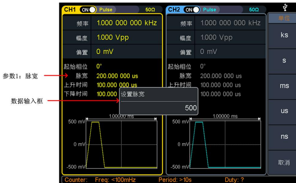
图 4-7：设置脉冲波的脉宽
