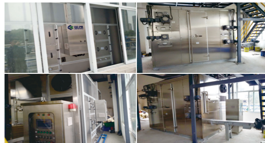
华兰生物工程重庆有限公司 污泥类型：制药污泥 前端压滤：叠螺机 湿泥量：2吨/天 湿泥含水率：80% 干泥含水率：30% 产品型号：JK-LSX1200WN
