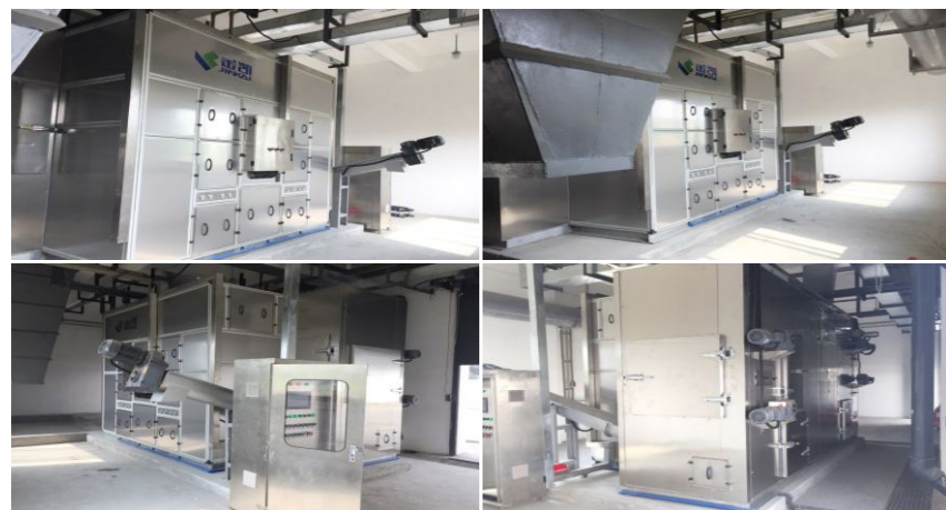
沃尔沃（成都）汽车制造有限公司 污泥类型：电镀污泥 前端压滤：叠螺机 湿泥量：3吨/天 湿泥含水率：83% 干泥含水率：30% 产品型号：JK-LSX2400WN
