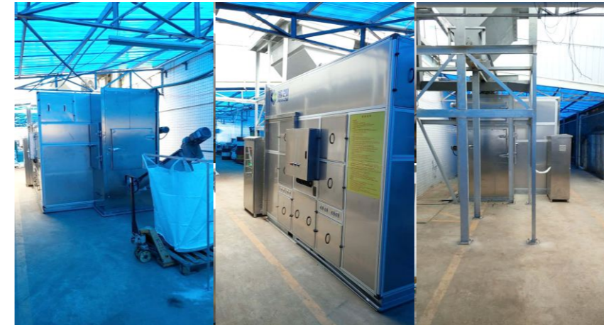
东莞康源电子有限公司 污泥类型:线路板污泥 前端压滤:板框压滤机 湿泥量:3.5吨/天 湿泥含水率:75% 干泥含水率:30% 产品型号:JK-LSX2400WN
