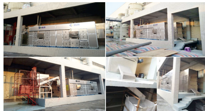
珠海领跃电路板有限公司 污泥类型：线路板污泥 前端压滤：板框压滤机 湿泥量：7吨/天 湿泥含水率：75% 干泥含水率：30% 产品型号：JK-LSX4800WN
