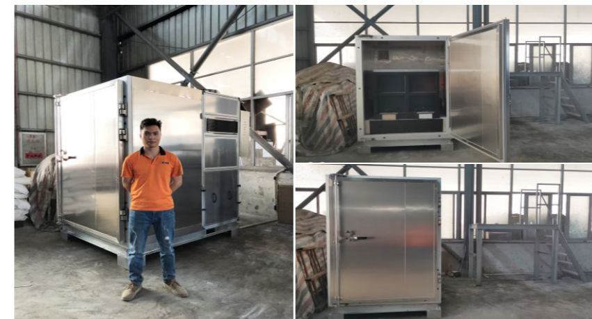
鸿顺金属拉丝制品有限公司 污泥类型:酸洗污泥 前端压滤:板框压滤机 湿泥量:0.5吨/天 湿泥含水率:75% 干泥含水率:30% 产品型号:JK-CSJ07WN-XT
