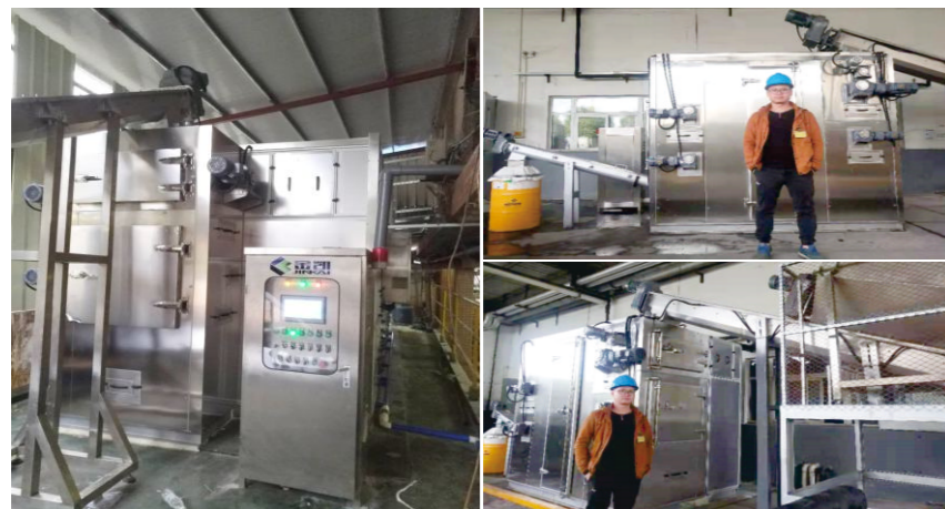
上海纳铁福传动系统有限公司（申江厂） 污泥类型：电镀污泥 前端压滤：板框压滤机 湿泥量：2吨/天 湿泥含水率：75% 干泥含水率：30% 产品型号：JK-LSX1200WN
