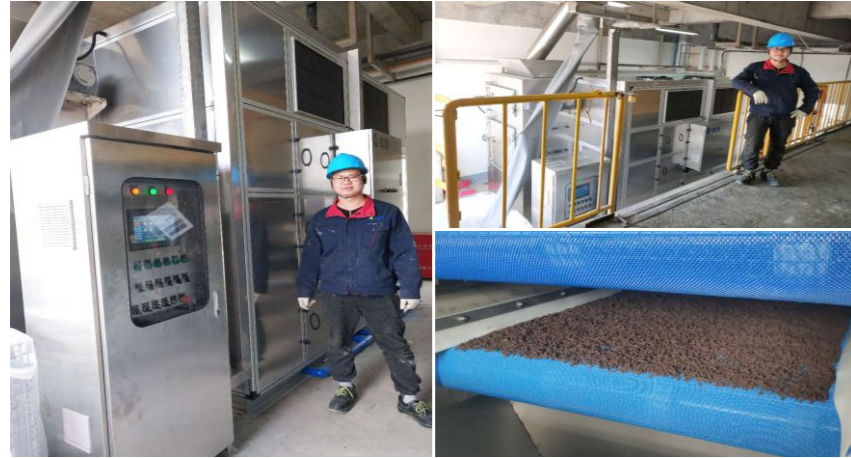
上海花王化工有限公司（金山区） 污泥类型：化工污泥 前端压滤：叠螺机 湿泥量：4吨/天 湿泥含水率：75% 干泥含水率：30% 产品型号：JK-LSX2400WN
