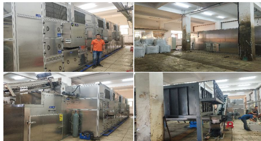
福建石狮市光华水处理有限责任公司 污泥类型:电镀污泥 前端压滤:板框压滤机 湿泥量:12吨/天 湿泥含水率:75% 干泥含水率:30% 产品型号:JK-LSX7200WN
