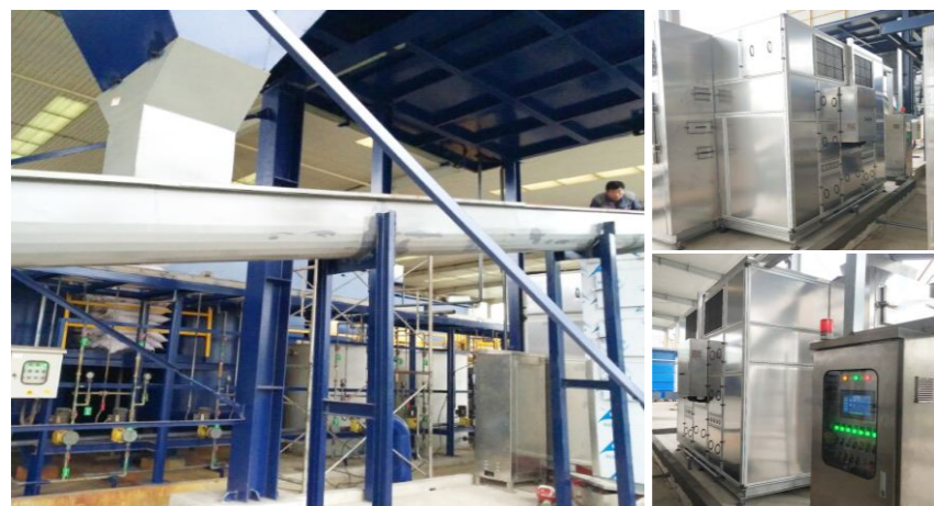
东风本田（武汉）汽车制造有限公司 污泥类型：电镀污泥 前端压滤：板框压滤机 湿泥量：4吨/天 湿泥含水率：75% 干泥含水率：30% 产品型号：JK-LSX2400WN
