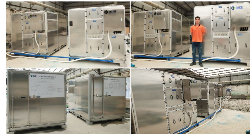
珠海信豪工艺有限公司 污泥类型:电镀污泥 前端压滤:板框压滤机 湿泥量:3.2吨/天 湿泥含水率:75% 干泥含水率:30% 产品型号:JK-CS15WN-XTx2
