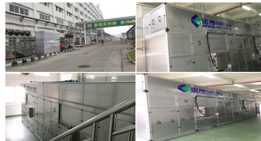
广东味极鲜调味食品有限公司（厨邦） 污泥类型：豆豉 前端压滤：离心机 湿泥量：20吨/天 湿泥含水率：50% 干泥含水率：35% 产品型号：JK-LSX4800WN
