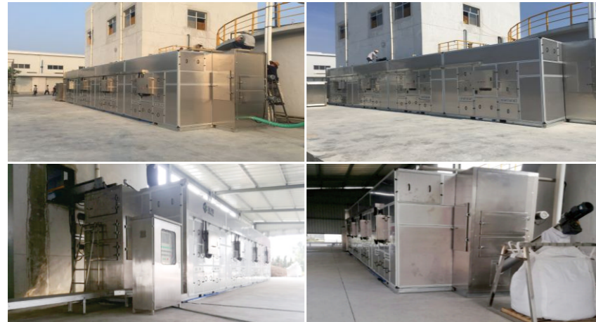
南山集团有限公司 (航空铝材) 污泥类型:电镀污泥 前端压滤:板框压滤机 湿泥量:15吨/天 湿泥含水率:75% 干泥含水率:30% 产品型号:JK-LSX9600WN
