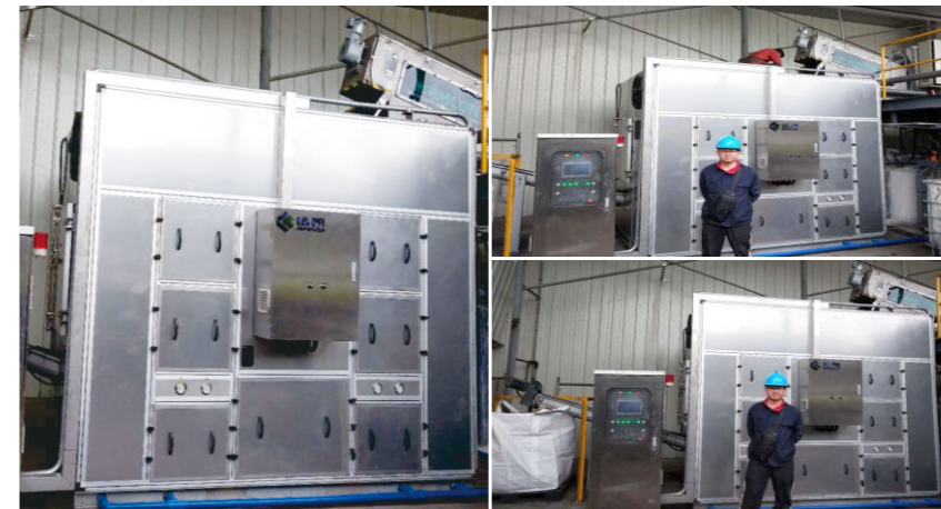
上海紫丹食品有限公司 污泥类型：印染污泥 前端压滤：叠螺机 湿泥量：2吨/天 湿泥含水率：80% 干泥含水率：30% 产品型号：JK-LSX1200WN
