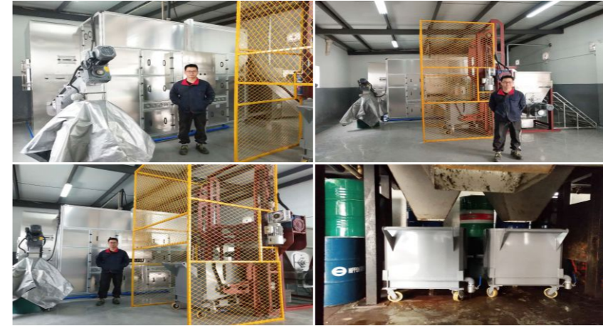
上海纳铁福传动系统有限公司（周浦厂） 污泥类型：磨床灰 前端压滤：板框压滤机 湿泥量：5吨/天 湿泥含水率：65% 干泥含水率：30% 产品型号：JK-LSX2400WN
