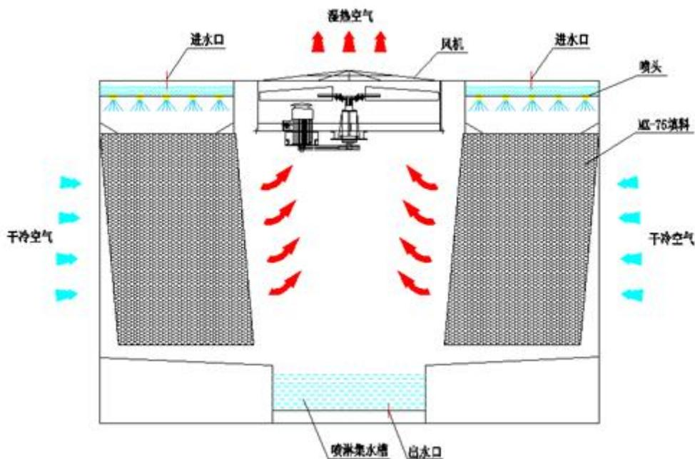
热源出来的热水流入冷却塔的上部散水槽中，受重力作用，通过散水孔均匀地喷洒在填料表面，同时，空气由冷却塔两侧的进风格栅进入，横掠填料，并与喷淋水形成横流，一小部分水被蒸发，从而带走热量，降低水温。热湿空气由顶部的通风机排到周围大气中，被冷却的水则落到集水盘后重新回到热源。
