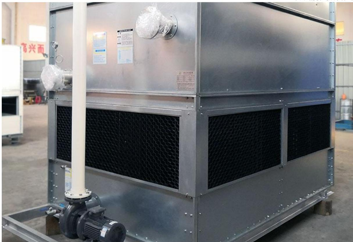
闭式逆流冷却塔是一种逆流式封闭循环水系统，此循环系统为自动喷淋控制系统，很大的程度上节省电力、水力。由于结构紧凑，机型小，可放置于车间内，因此可用于中频电源冷却，机械水套冷却等；单位空间内的换热面积较大，因此更适用于温差较小的低温度（35-30℃）冷却项目，如水源热泵机组群、空压机等的冷却。
