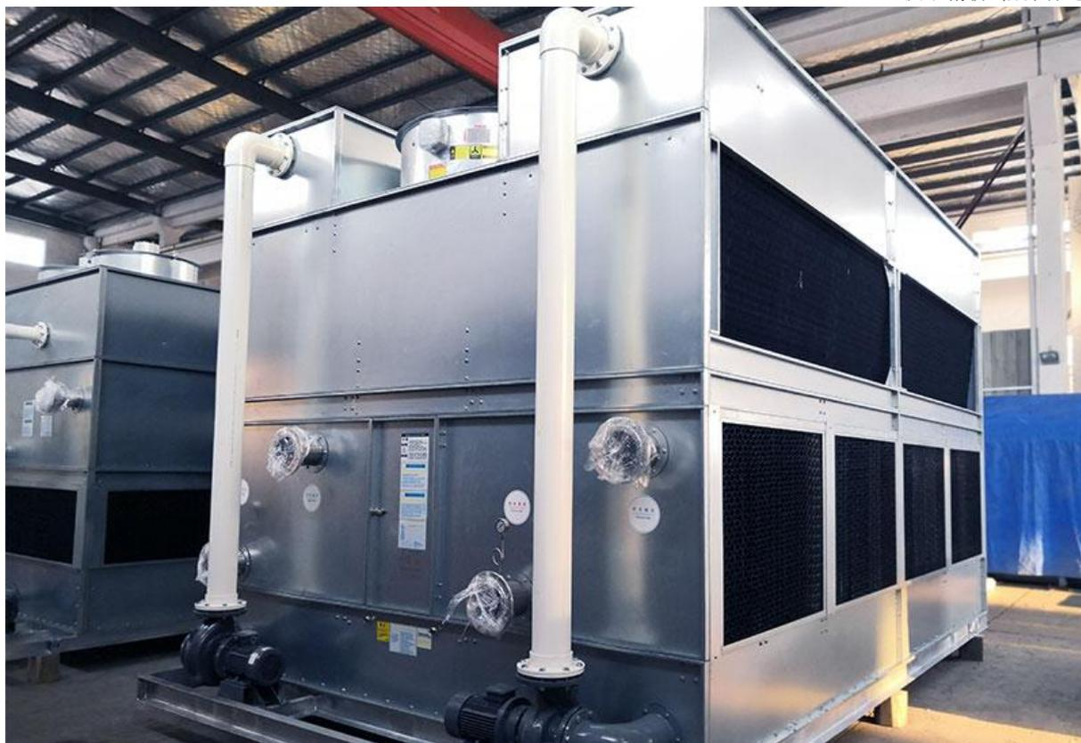
闭式横流冷却塔是由排风系统，喷淋系统，填料预冷系统，盘管换热器、及机组壳体组成，是由外界空气从冷却塔侧面进入机组，横向流过填料和冷却器后向上排出机组，与喷淋水流向垂直相交，冷却盘管的流体介质。
