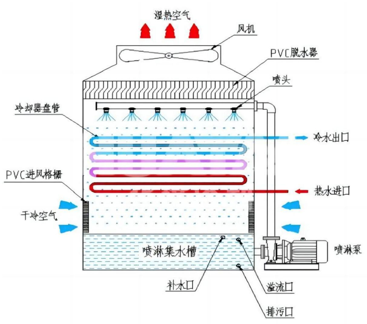
工作流体（纯水或其它液体）在闭式冷却塔的盘管中循环，工作流体的热量经过盘管散入流过盘管的水中，同时机组外的空气从盘管底部侧面上的进风格栅进入，与水的流动方向逆向，逆向流经盘管，一小部分水蒸发而吸走热量，热湿空气由冷却塔顶部的排风机排到大气中；其余的水则落入底部水槽中，由水泵再循环至水分布系统又淋回到盘管上。
