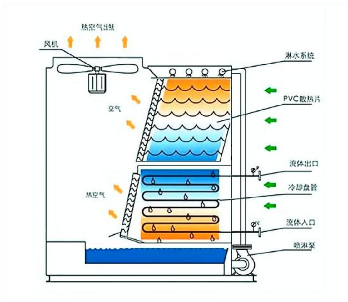
工作流体（纯水或防冻液）在闭式冷却塔的盘管中循环，工作流体热量经过盘管散入流过盘管的水中同时机组外的空气从机组侧面上的进风格栅进入，与水的流动方向垂直，向上流经盘管一小部分水蒸发而吸走热量，热湿空气由冷却塔顶部的通风机排出到大气中。其余的水落入底部水盘，由水泵再循环至水分布系统又回淋到盘管上。
