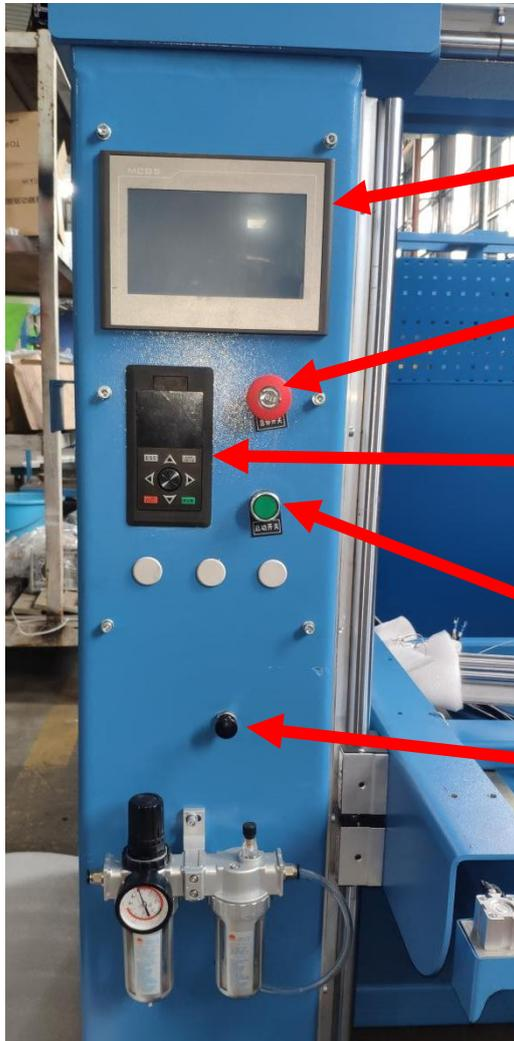
1、触控显示屏，用于调节拉丝轮的转速，还可以在屏幕上看到智能操纵杆的按钮功能说明。
