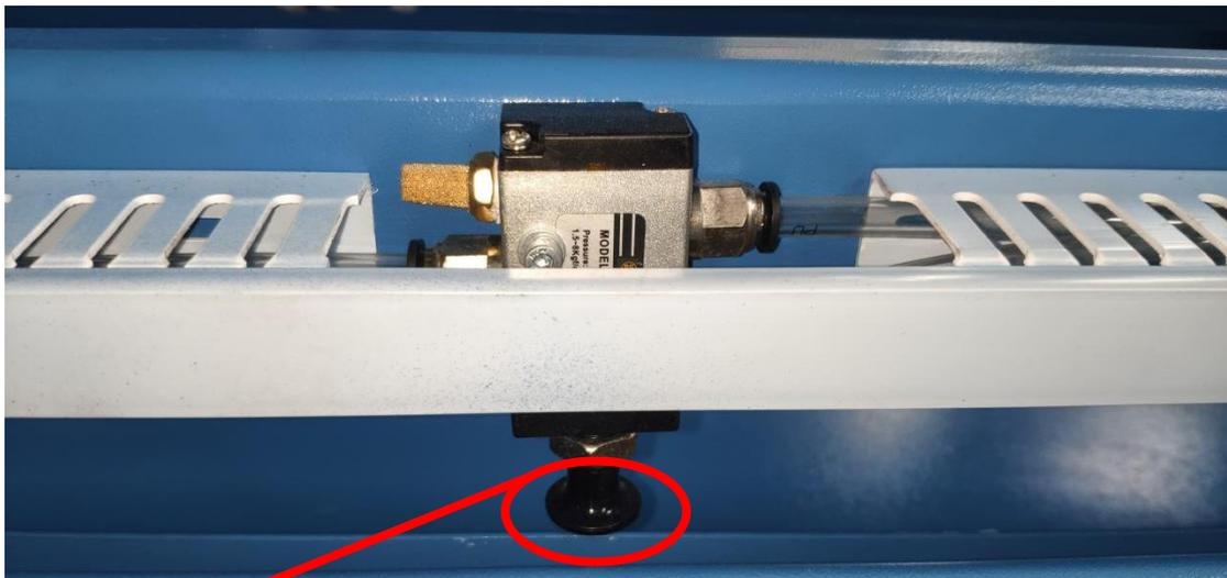
气阀开关，此开关是用于锁紧或松开平台移动的，实现平台前后移动一键锁定。
