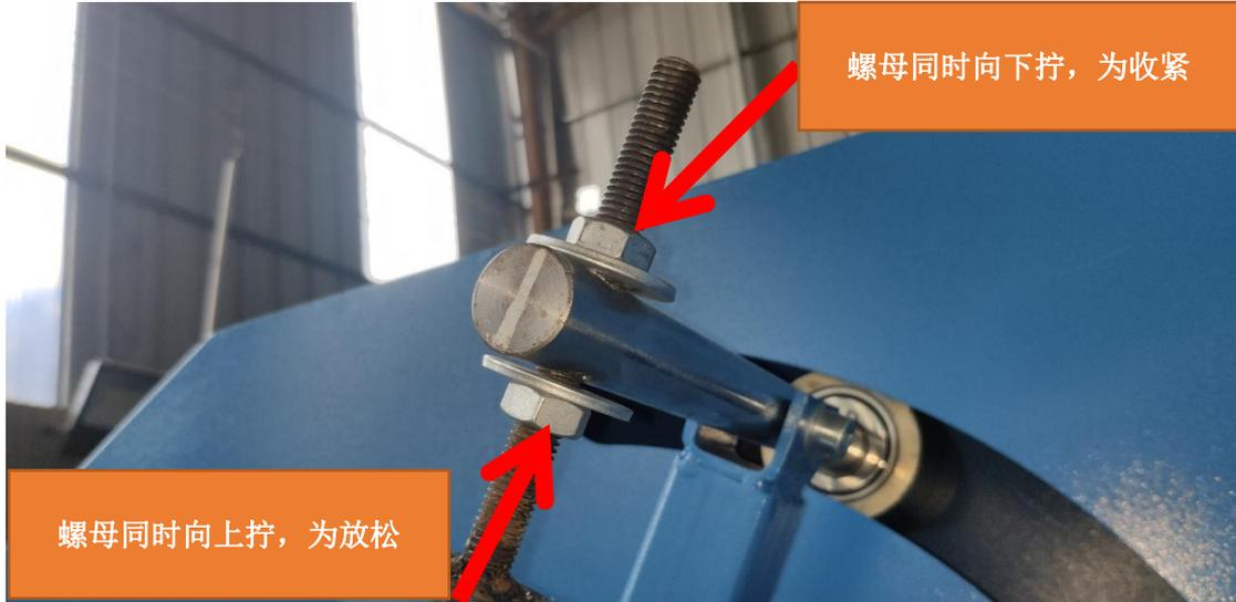
图一，机器正后方，砂带晃动调节螺丝，遇到砂带前后跑偏时，可通过此螺丝调节平衡。
