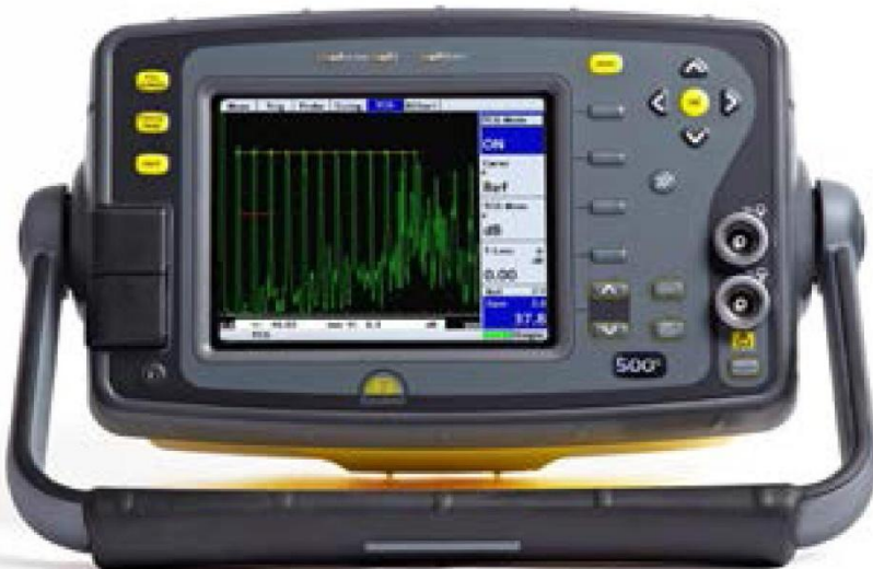
Sitescan 500S 超声波探伤仪的 TCG 模式
