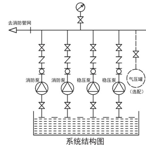
设备设有消防泵和稳压泵，也可不设稳压泵。
