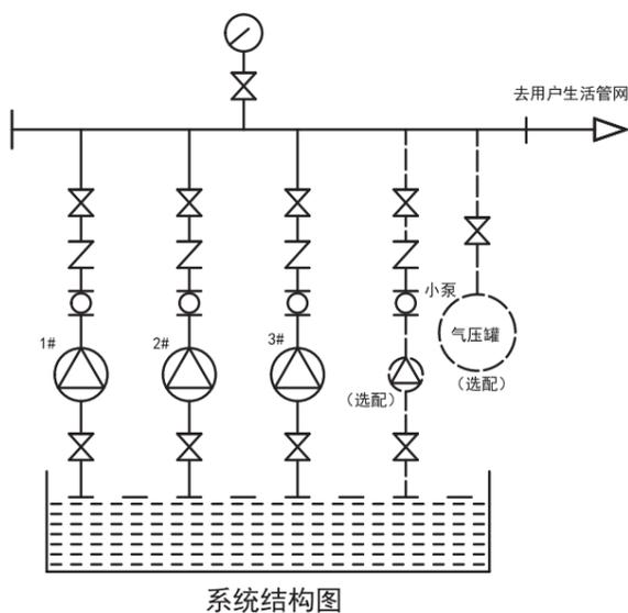
当用水量增加时，水泵将加速至另一稳定转速，当用水量继续增加且变频器输出频率达到50HZ（即电机转速达到最大转速）时。系统运行有两种方式：
