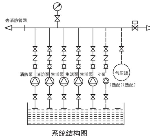
设备分别设有消防泵和生活泵。生活泵供生活用水和消防管网稳压，消防时生活泵关闭，启动消防泵供水。
