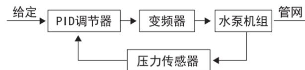
系统通过安装在出水总管上的压力传感器将压力信号转换成电信号, 并送给PID调节器进行运算处理, 同时与设定值不断进行比较, 其输出信号送至变频器进行VVVF控制, 自动调节变频器输出频率, 从而改变水泵运转速度, 当用水量增加时, 水泵运行速度加快, 当用水量减少时, 水泵运行速度减慢, 并通过可编程控制器自动控制多泵循环, 自动加减泵, 先加后减, 先减后加, 总之, 通过改变供水组水泵的转速和台数, 使设备供水量与用水量达到平衡, 从而实现恒压的目的。
