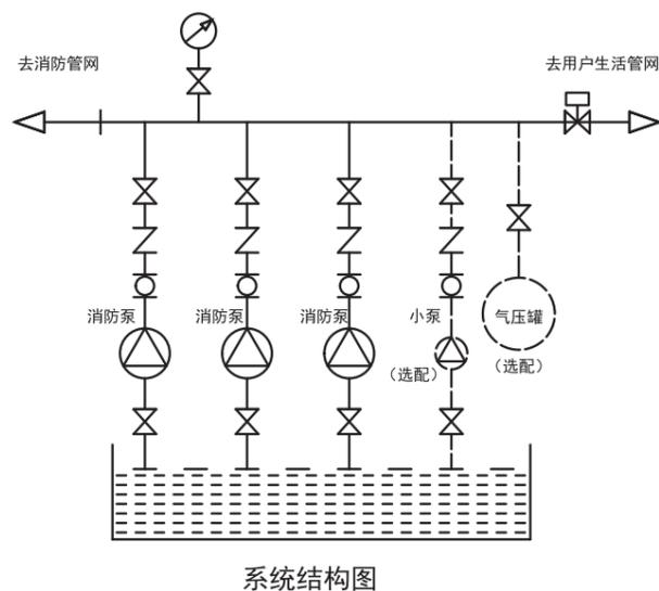
设备只设消防泵，没有生活泵，平时生活供水由消防泵供给，当发生火灾时，关闭生活管网，消防泵直接供消防用水。
