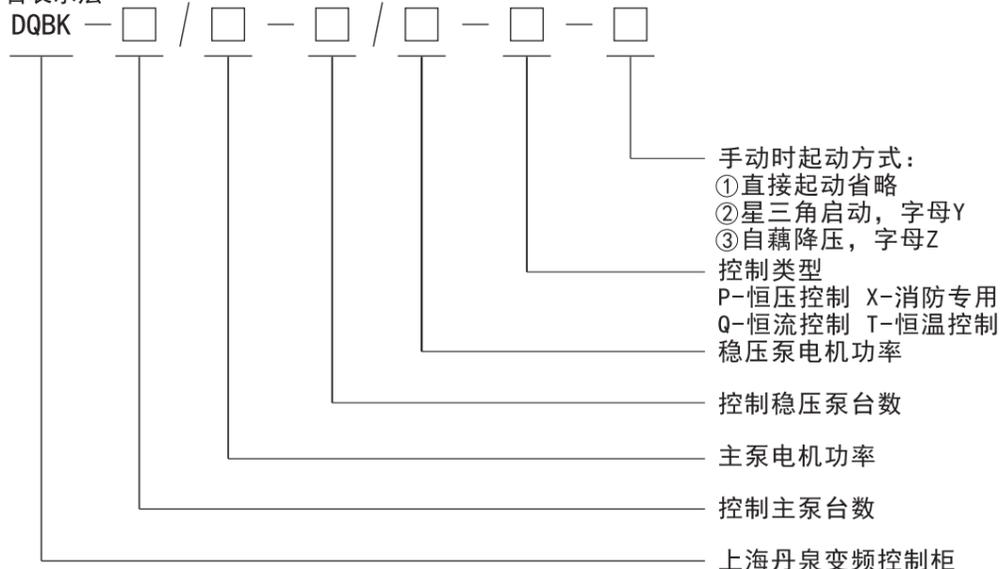
示例 DQBK-2/18.5KW-2/3KW-P-Y, 表示控制二台18.5KW水泵和二台3KW水泵变频恒压供水, 且手动启动时二台18.5KW水泵为星三角降压起动的变频柜。
