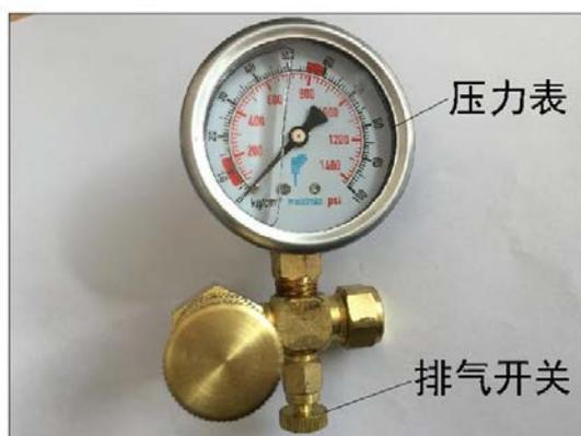
6. 用软管把氮气瓶和减压阀相连, 慢慢拧开氮气瓶阀门
