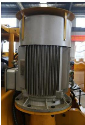
电机是凿岩动力系统的核心，该款电机性能稳定，噪音小，安全系数高，日常维护只需按保养表保养即可。非正常状态时请注意务必先切断电机的高压三相电，不可盲目私自拆卸。
