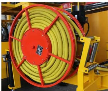
电缆卷盘为钻车专用型，能适应恶劣的工作环境，频繁的移动、拖拽和矿石摩擦对电缆有着高标准的耐磨擦要求。该款电缆不存在断芯、开裂、鼓包、扭曲等质量问题。电缆的收放由电缆卷盘的液压马达控制，控制开关在驾驶座位的右手边，在开车时可自由的收放，无需专人操作。在收放电缆时注意电缆没有缠绕卡在特殊位置，保证设备安全。
