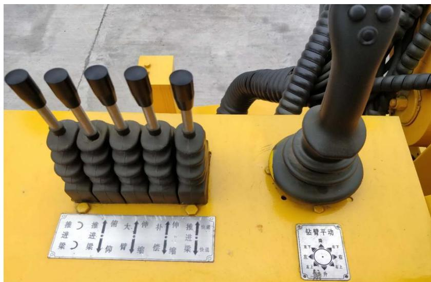
图 4：钻臂控制面板
