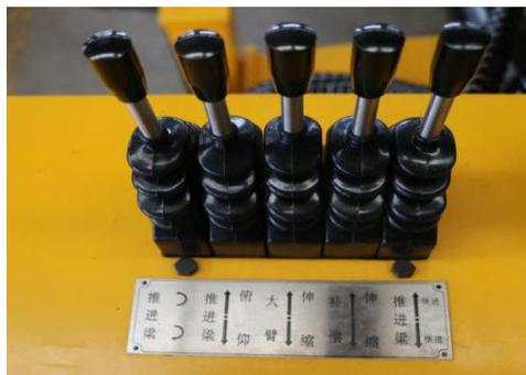
操作台由左、右操作台组成，上面集中了钻车的各种操作阀、控制器、仪表、调节阀等开关控制元件，通过操作人员各项操作来完成钻车的钻孔作业。由于控制功能相对较多，因此非操作人员严禁动手，以免造成设备故障。相关人员必须先培训后才能操作钻车！
