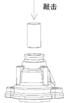
2. 铜套与壳体采用过盈配合，需使用上述安装工具安装前铜套
