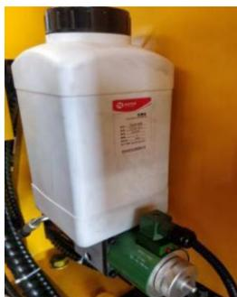
钻机是通过凿岩机来实现冲击凿岩的，良好的润滑是保证凿岩正常工作的必要条件，油雾润滑阀块供给凿岩机润滑油雾。**润滑油量 300 滴/小时，用油来源于油箱，每星期需补油一次。**
