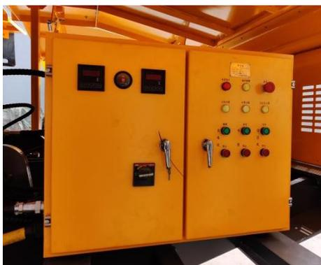
电器柜是整个钻车的电器控制系统核心，采用的进口西门子和 ABB 电器元件，质量和品质有保证，从源头上减少了钻车故障率。本款电器柜是本公司自主设计，可防水及一定范围的爆破冲击波，在维护方面无特殊要求。日常工作和停机状态时请将柜门锁住，防止灰尘雨水进入和人员误动造成故障。在维修维护时应首先切断高压电源，应在专业的电工指导下进行操作，严格按照安全要求作业。
