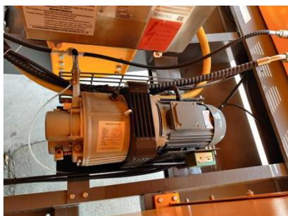
空压机是给凿岩机提供润滑气雾的动力设备，该款空压机在气压达到设定压力时自动停止，也可手动控制停止，因带有冷却风扇，所以平时更换空气滤或加注润滑油是请务必断电后处理，在工作状态时严禁任何物体靠近风扇区。
