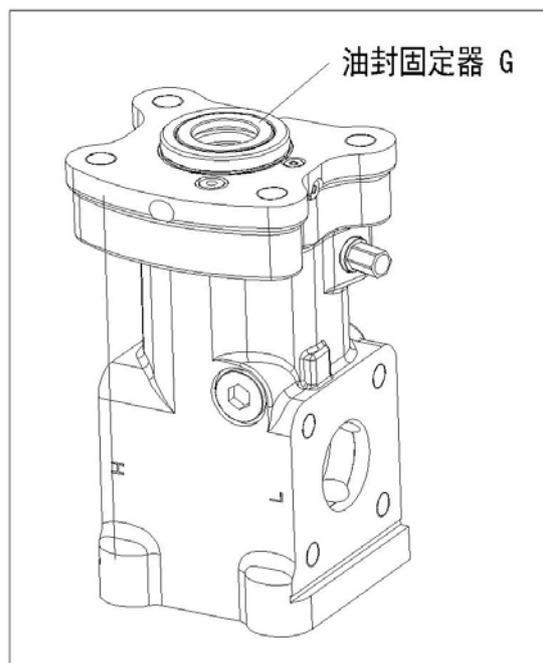
使用塑料锤将油封固定器安装到位, 油封固定器的端面高于中缸体的端面
