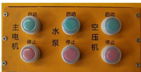
控制盘上面有详细的各种操作指示标牌，操作人员只需按上面的指示按步骤操作即可实现整车的操控。该控制盘的作用是方便操作人员直接集中的控制钻车的电机水泵和空压机等设备，遇到紧急情况时能及时停机，提高工作效率。
