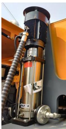
本款水泵是专用于钻车的离心泵，该水泵由配置的 3KW 电机带动水泵工作，水流量为每小时 4 立方米，有效扬程为 72 米，完全满足钻车用水需求和供水压不足的情况。在给钻车供水时不可直接选用污水和带有泥沙的河水，务必将水过滤后使用，以防破坏水泵钻机，堵塞钻杆。
