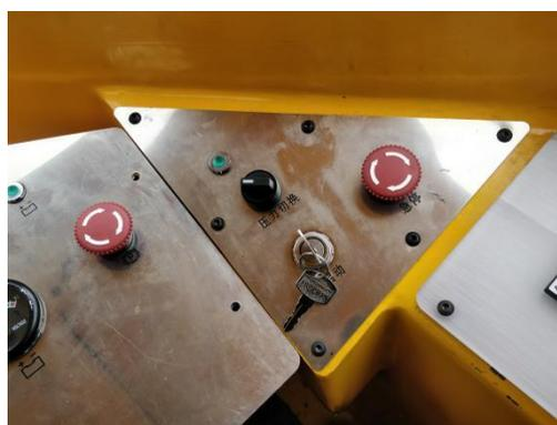
驾驶台是专门用来驾驶钻车行走的地方，包含了驾驶装置、照明系统、驻车系统、油门系统等，钻车操作人员在驾驶时应熟悉钻车的所有驾驶操作要求，非操作人员严禁操作。停车不用时务必拔掉启动钥匙，关闭电源。
