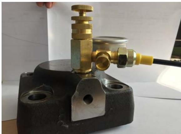
★ 充装氮气, 观察压力表, 待指针到  $85\text{kg}/\text{m}^2$  时关闭氮气瓶阀门
