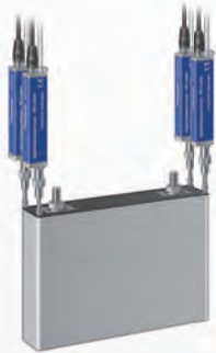
锂离子电池的平坦度测量
