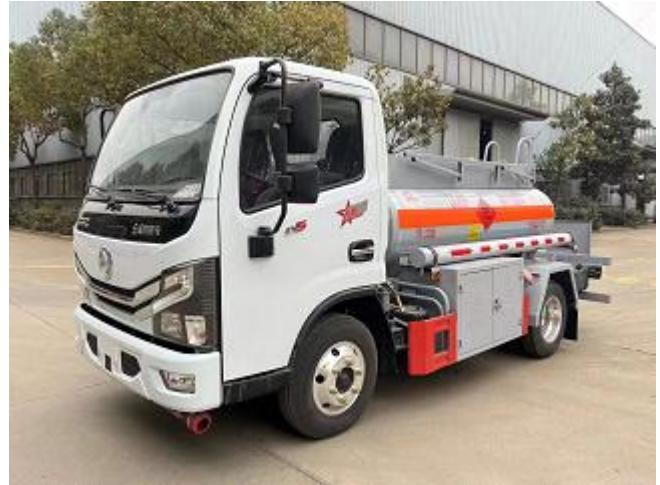
功能：根据不同的用途和使用环境有多种加油或运油功能，具有吸油、泵油，多种油分装、分放、等功能。组成：加/运油车专用部分由罐体、取力器、传动轴、齿轮油泵、管网系统等部件组成。管网系统由油泵、三通四位球阀、双向球阀、滤网、管道组成。
