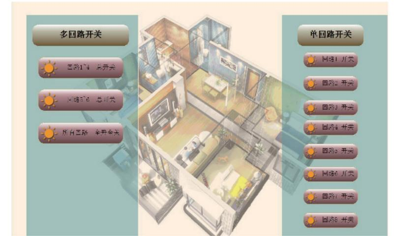
十寸触摸屏端中控，主要应用在一些中小型规模的智能照明控制系统中。触摸屏的控制页面不显示任务栏，可通过上拉选择具体楼层房间，然后选择对应的控制页面，实现远程集中控制功能，如：开关控制、状态实时反馈、调光控制、场景控制、定时控制等。
