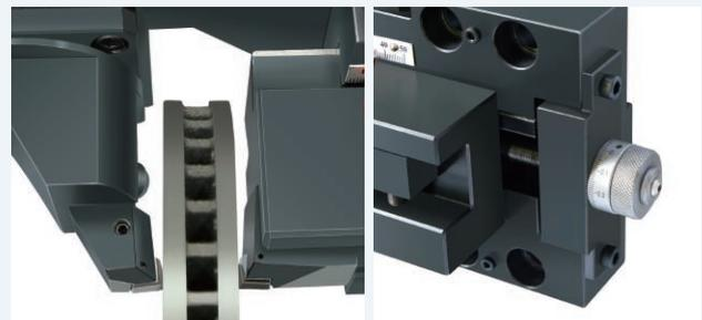
煞車盤二面同時車削
