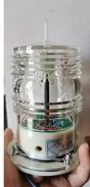
HB90 型 LED 航标灯由铸铝合金外壳、抗紫外线丙烯酸塑料菲涅尔透镜、超高亮航标专用 LED、数字编码闪光器、日光开关等组成。航标灯采用数字编码技术，它可在现场编码产生 256 种符合（IALA）国际航标协会及 GB4696-84 国家标准的闪光灯质。该灯器广泛应用于浮标、灯桩、航道港口、码头、桥梁、海上、水中障碍物等场合用作导航标志灯。灯器可根据不同射程的要求，可以通过增加光源亮度以达到加大光强的目的。该灯器具有光效高、功耗低、寿命长、抗振动，免维护，耐腐蚀等优点。光源寿命大于 10 年。
