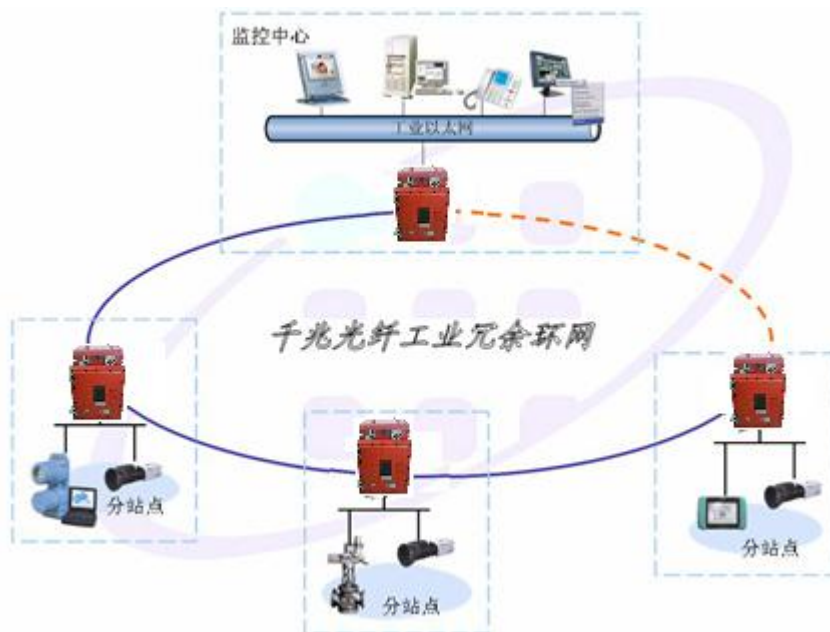
工业以太网单环网平台故障自愈示意
