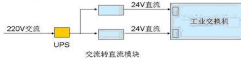
井下环网交换机电源连接图
