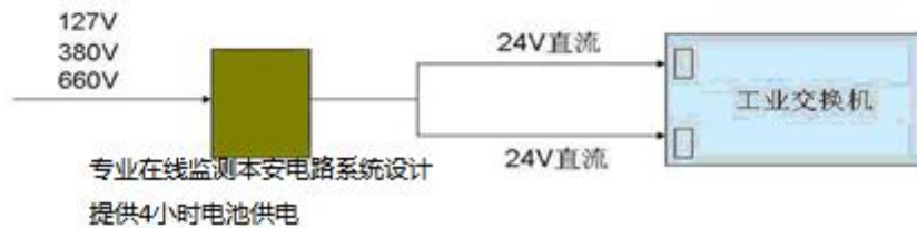
井下环网交换机电源连接图
