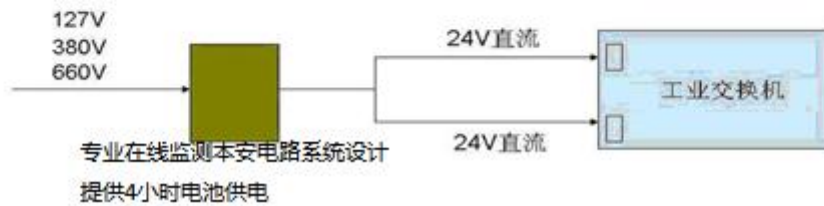
井下环网交换机电源连接图
