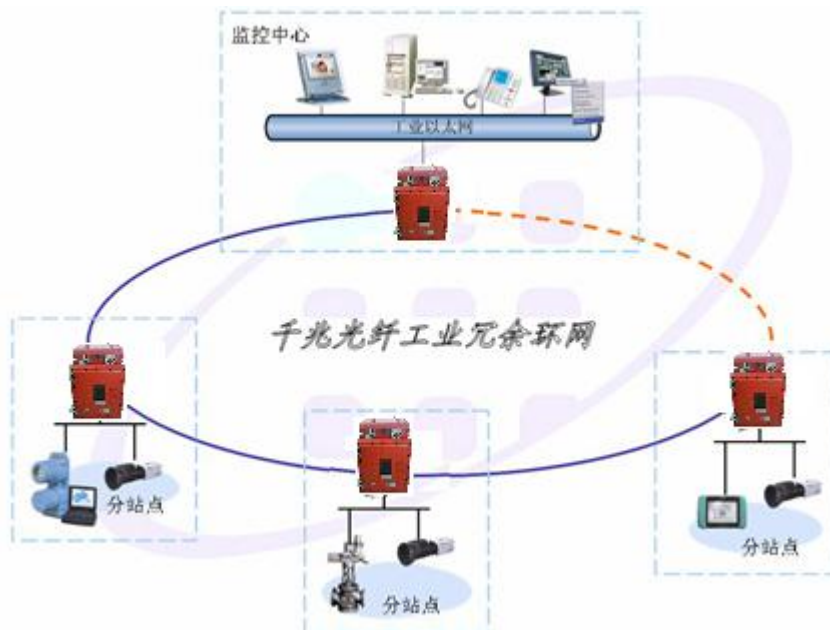
工业以太网单环网平台故障自愈示意
