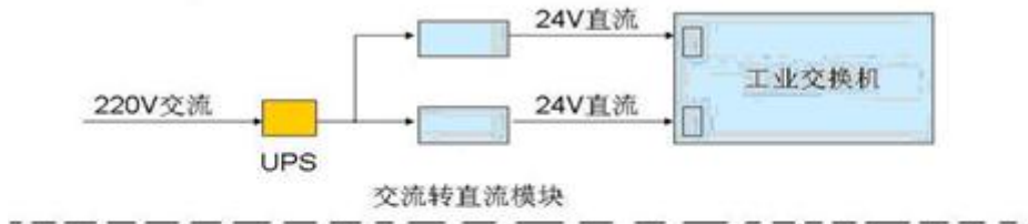
井下环网交换机电源连接图
