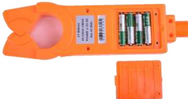
图 5 采集器电池槽
