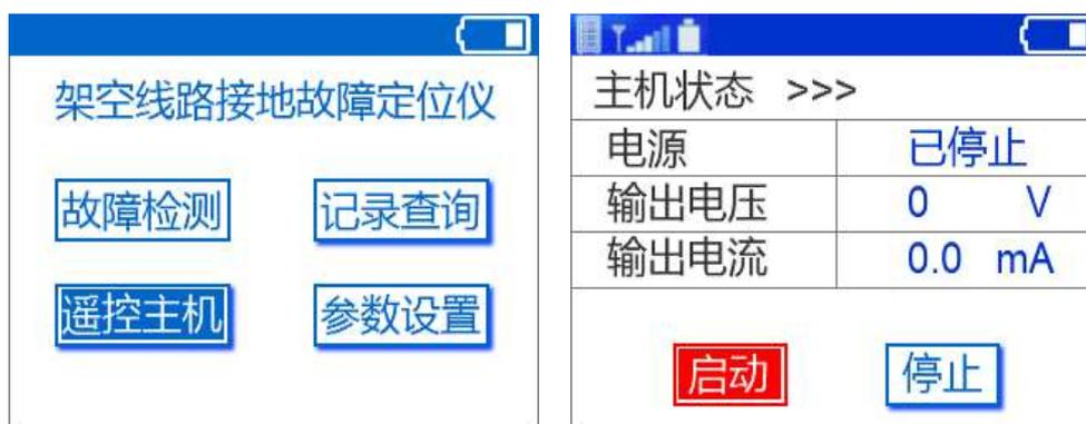
图 22 遥控主机示意图
