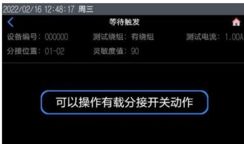
此时可手动或电动操作有载分接开关，有载分接开关动作完毕后，仪器自动进入“波形预览”界面。
