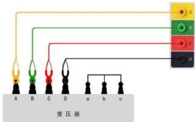
拆去被测变压器的所有引线，将非测试端（通常为中压侧、低压侧）分别三相短路接地。仪器在关机状态下，将测试钳黄、绿、红、黑依次夹到被测变压器的调压侧（通常为高压侧）套管的A、B、C三相和中性点上，然后将测试线另一端的黄、绿、红、黑线分别接在仪器的A、B、C、0端子上。
