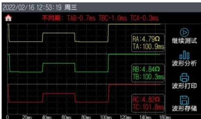
波形从上到下三个区域分别显示的是 A、B、C 三相的动作波形，在每条波形曲线下面有一条水平直线是零电流线，当切换过程中有断点时，曲线将与零电流线重合。仪器自动计算出三相波形的过渡电阻、过渡时间和三相不同期性，此部分仅供参考，对于自动测量有异议时可使用“波形分析”手动分析波形数据。对于 M 型和 T 型开关，其切换开关总是在单双之间作往返动作，所以测一次单到双（如 1→2），再测一次双到单
