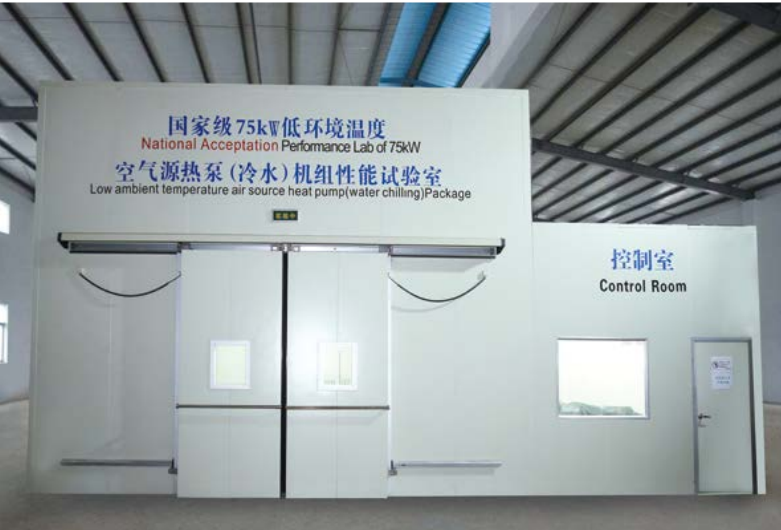
国家级 75kW- -25^{\circ}\text{C} 低环境温度空气源热泵（冷水）机组（试验范围 -25^{\circ}\text{C} ~ +60^{\circ}\text{C} ）
