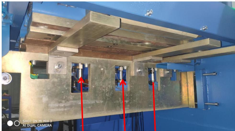
本设备有顶针定位，产品无需点焊固定。这是三个是顶针气缸！
