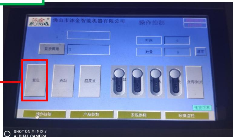
2.9 第九步，踩一下脚踏开关，压板下压，再踩一次，进行空走测式，检查焊枪行走的轨迹是否和产品需要焊接的一致！
