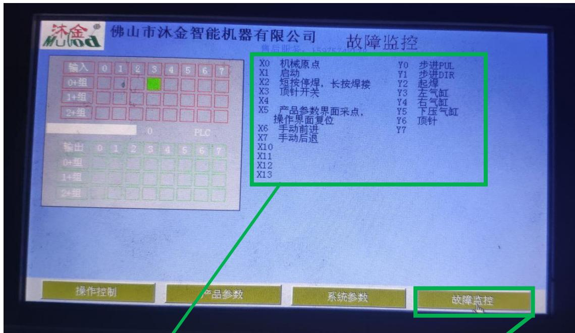
1.2、设备供电无误的情况下，机械电路问题，用此区域标号，对应电箱内线标号，进行排查。
