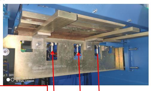
本设备有顶针定位,产品无需 点焊固定。这是三个是顶针气 缸!
