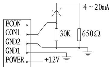
图17: 4~20mA仪表控制信号的接法
