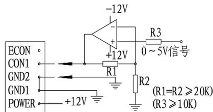
图16: 0~5V控制信号的接法
