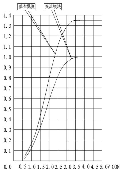
图18: 三相模块控制曲线
