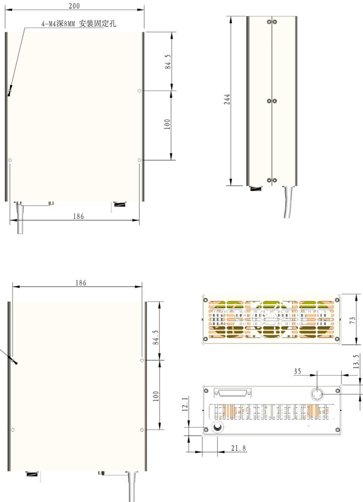
激光隔离器输出头尺寸如下图所示（单位：mm）
