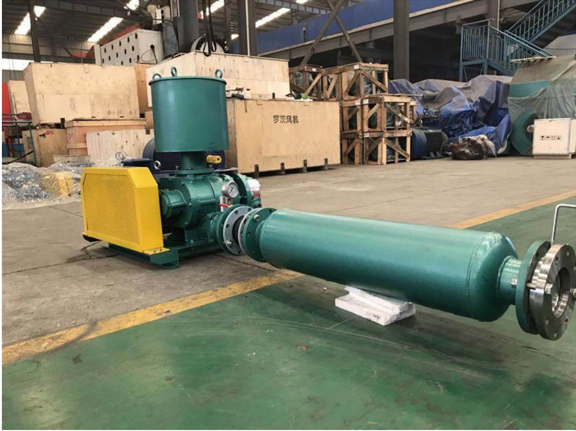
主要配件（机壳、端盖、轴、叶轮）全程采用数控加工中心制作完成，主要外购件采用日本NSK轴承，瑞典SKF轴承，美国盖茨皮带，日本TTO氟橡胶油封，提高了风机工作效率，降低了噪音，将风机的使用寿命延长至10年以上！
