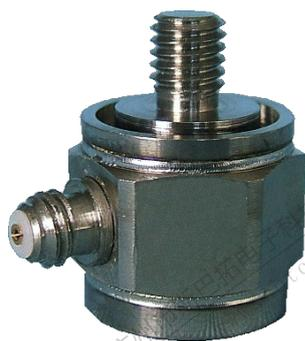
可测量 $\mu$ s级响应动态力。静态校准持续时间长，刚度高，适宜装入机器和设备中不影响力学性能。大量使用在冲击力测试，瞬间力检测等
