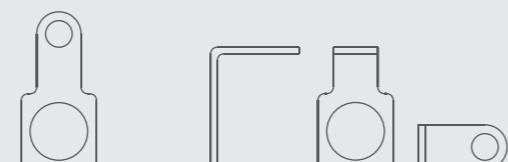
附件规格：安装孔径Φ26\Φ39\Φ51为常用规格；
