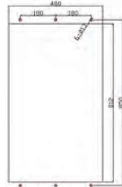
穿墙安装开孔尺寸
