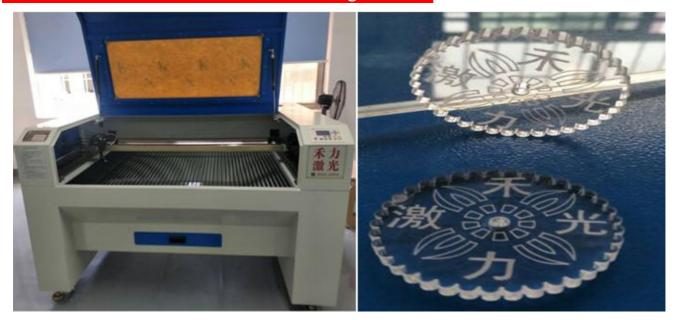
机器外形尺寸:长 1900mm\*宽 1580mm\*高 1120mm(可切割尺寸 1300\*900mm)
