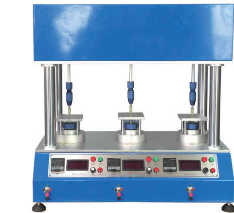
■ 三工位弹簧式寿命打击试验机
