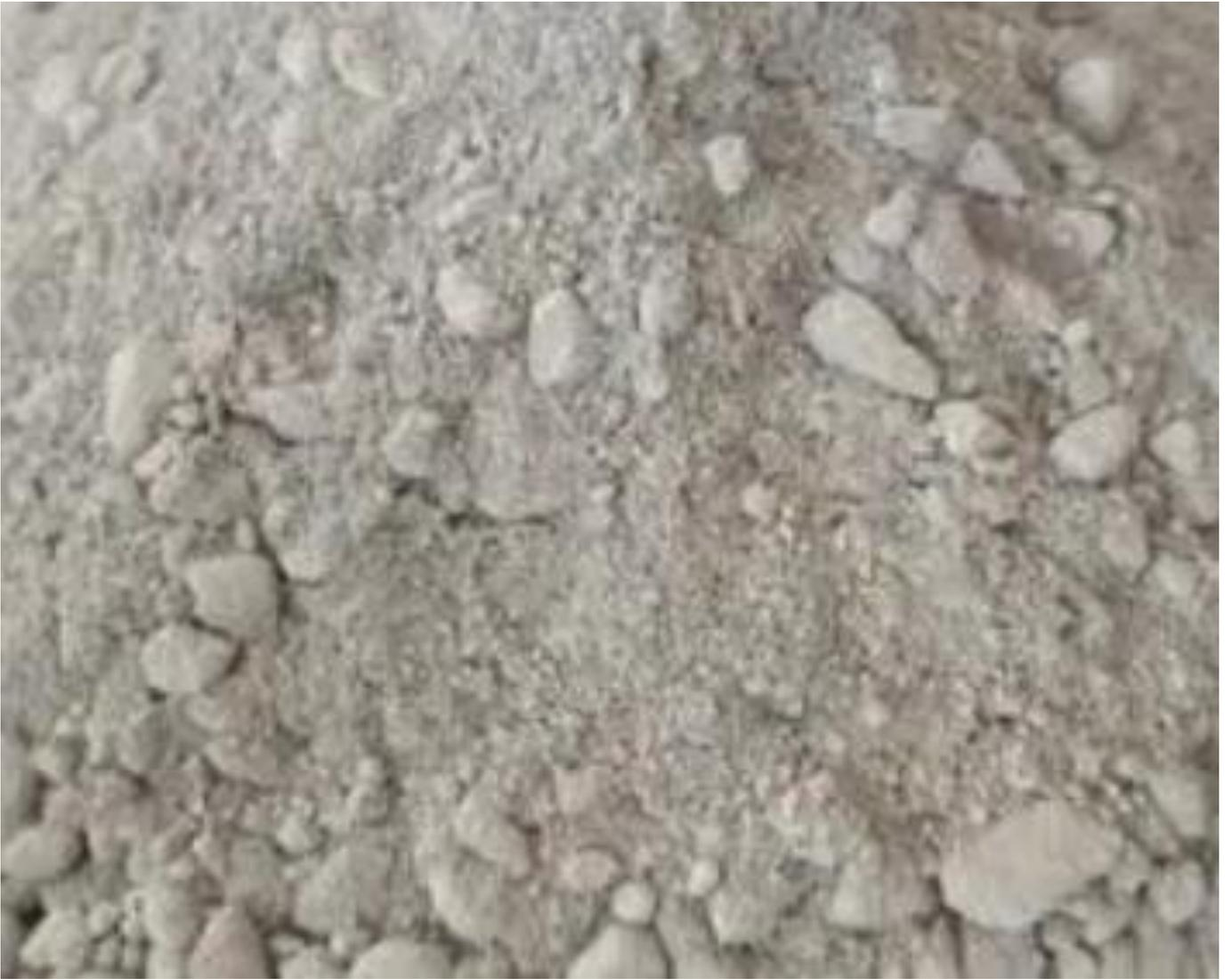
3) 骨料的含泥过高，主要是砂中的污泥和石中的山皮土、石粉。浇筑之后，若上浮至表层，就会直接导致表层的硬度降低。
