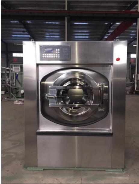
XGQ 悬浮式全自动洗脱机是集洗、脱一体变频调速全自动洗脱机，内置支承式减震系统，机器运转平稳无噪音。此系列的全自动洗脱机内滚筒、外壳采用优质不锈钢制作，确保机器使用寿命。外置电脑控制触摸式面板，分自动和手动两种控制模式。在减速制动时由变频器和电阻刹车装置共同完成，保证了机器操作更方便。
