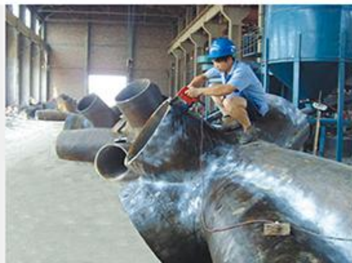
铸钢节点三方无损检测
