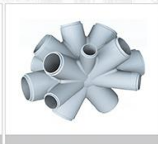
福州奥体中心工程 节点
