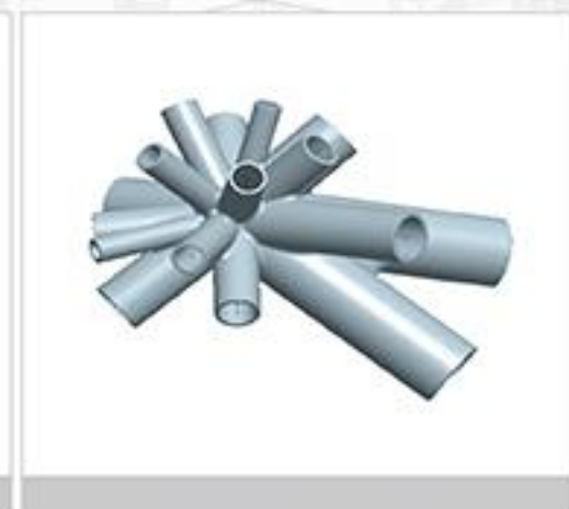
福州奥体中心工程 节点
