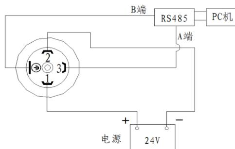
1. 请注意在安装变送器时，选用的线缆应不低于变送器的防护等级，同时为保证 IP54 的防护等级应选用直径为
