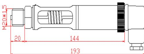
高温型压力变送器螺纹安装尺寸
