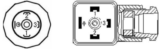
二线制 4mA~20mA 电流输出接线图(JYB-KO-HA\*)
