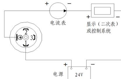
三线制 0V~5V 电压输出接线图(JYB-KO-HV\*)
