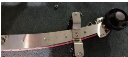
第5步:拧上吸扒后部小轮即可完成胶条安装。
