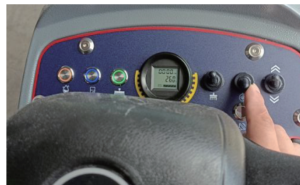
第1步: 打开电源总开关, 下拨扒头升降按钮, 放下吸水扒头;
