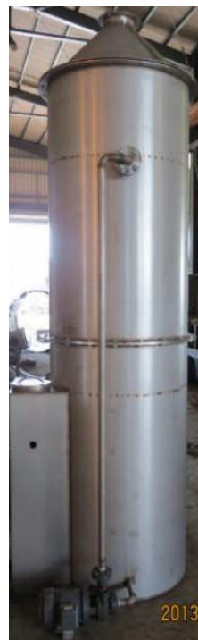
脱臭、尾气处理塔
