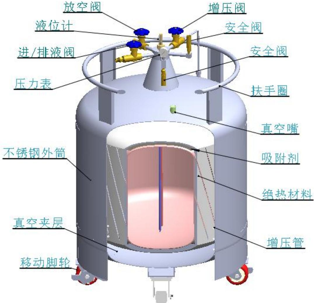
▲阀门管路及安全系统由进/排液阀，增压阀，放空阀；液位计，压力表；双安全阀组成。可提供连续的进/排液体、持续增压、持续泄压；显示液位和内胆工作压力；双安全自动控制阀及双重安全保护措施，压力超高(工作压力)自动泄压，安全可靠；
